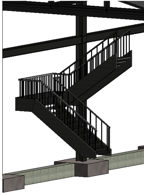
Figura 63: Resultado final escaleras 3D. Oficinas.
