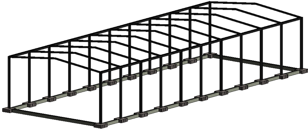
Figura 207: Inserción de pórticos en nave cerrada. Almazara
