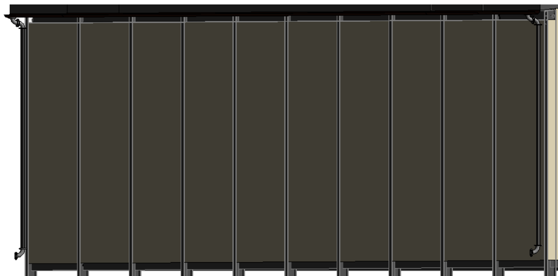
Figura 226: Inserción de canalón y bajante en nave cerrada 2. Almazara
