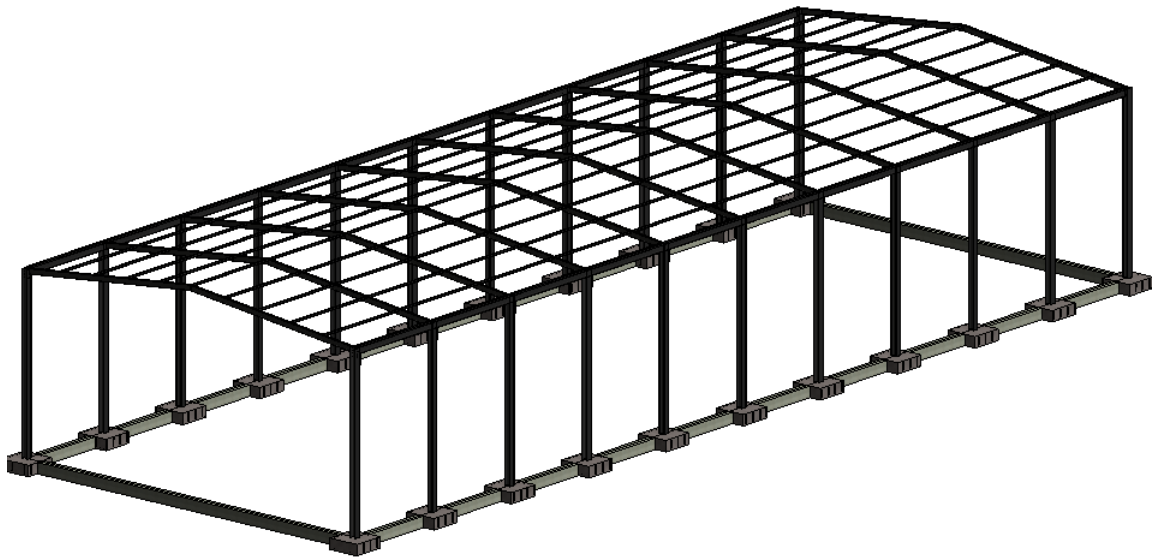
Figura 208: Inserción de correas en nave cerrada. Almazara
