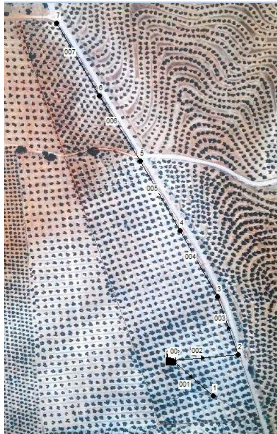
Figura 5.1 Modelo para simulación de la instalación en EPANETv2 sobre imagen área de la finca
