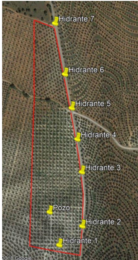
Figura 3.6 Imagen aérea con ubicación de hidrantes y pozo
