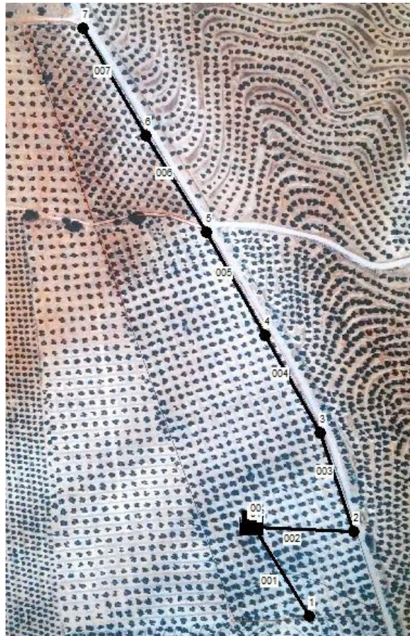
Figura 9 Modelo para simulación de la instalación en EPANETv2 sobre imagen área de la finca
