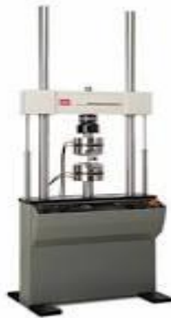
Figura 15: Máquina MTS 810 Material Testing Systems de ensayo de resistencia a la compresión.
