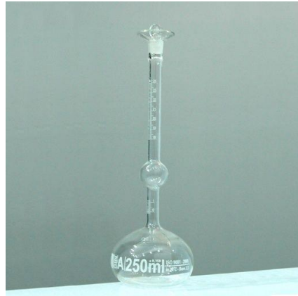
Figura 8: Frasco volumétrico de LeChatelier para la obtención de la densidad relativa.
