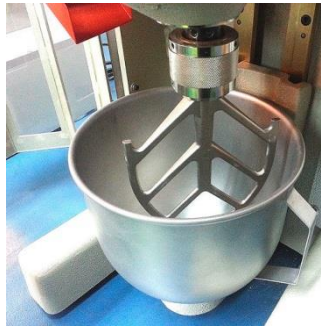
Figura 10: Amasadora planetaria empleada para mezclar homogéneamente las materias primas.
