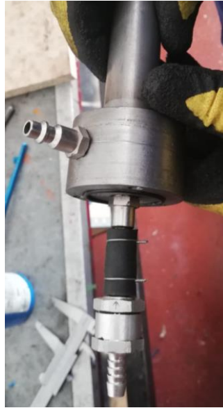
Ilustración 81. Conexión de válvulas con la bomba
