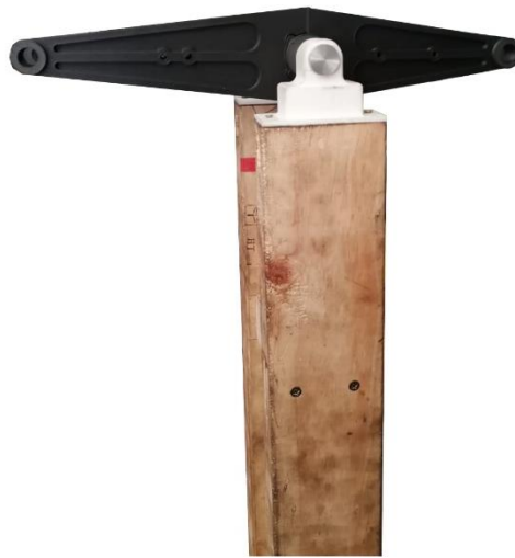
Ilustración 76. Montaje de balancín y su eje
