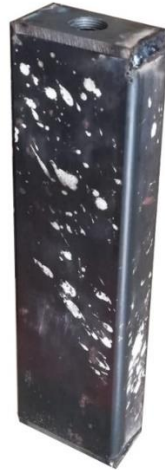
Ilustración 77. Estructura de sujeción del pistón
