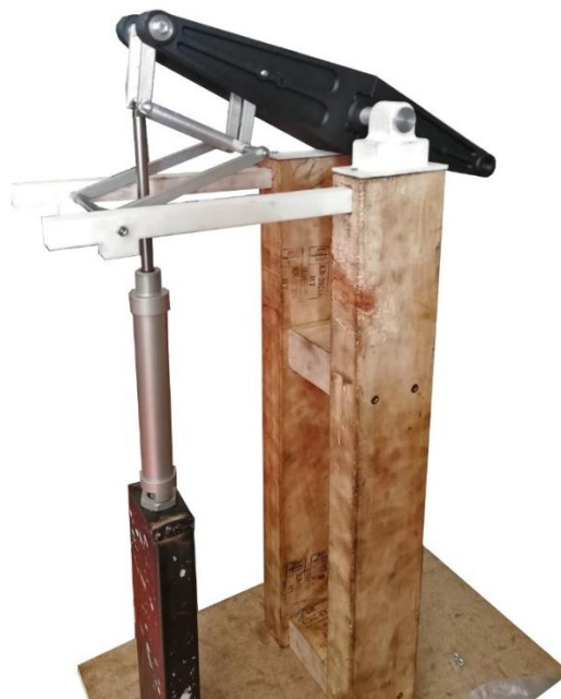
Ilustración 78. Montaje pistón y barras movimiento paralelo
