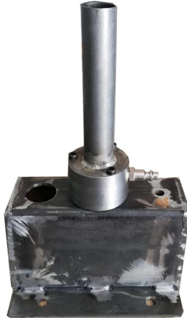
Ilustración 83. Unión de la bomba al depósito de agua
