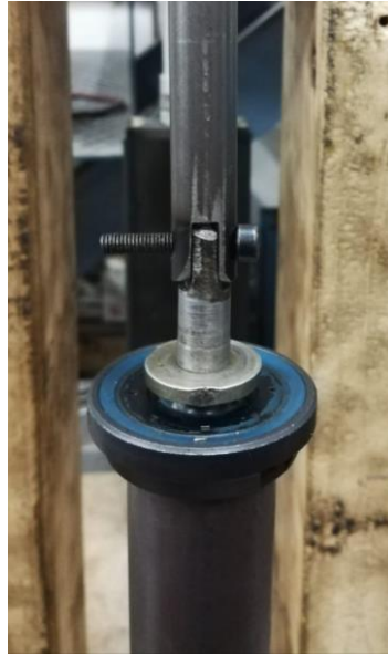
Ilustración 84. Detalle articulación entre la varilla y el vástago de la bomba
