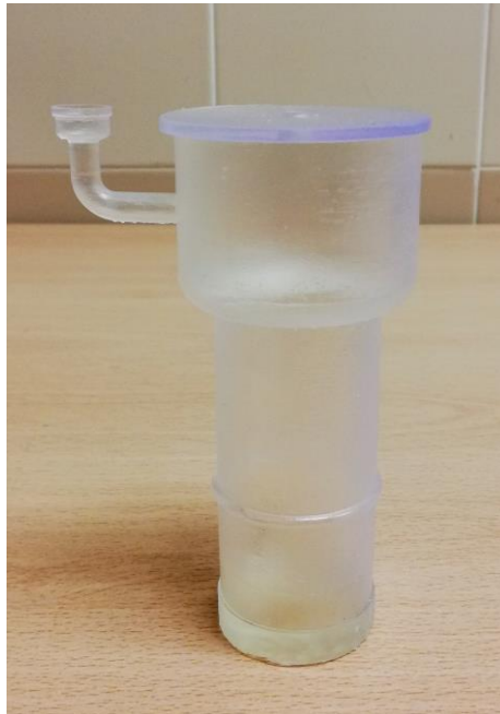
Ilustración 66. Resultado impresión de bomba de aire
