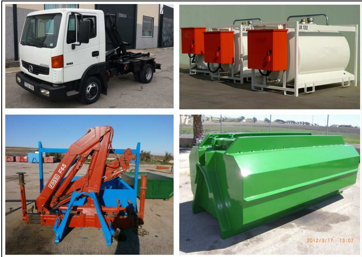
Figura nº 77 : Camión de servicio modelo Nissan Atleon 56.15. portacontenedores y contenedores para diferentes utilidades ( cisterna de gasoil, cajon-pluma y cisterna para riego).
