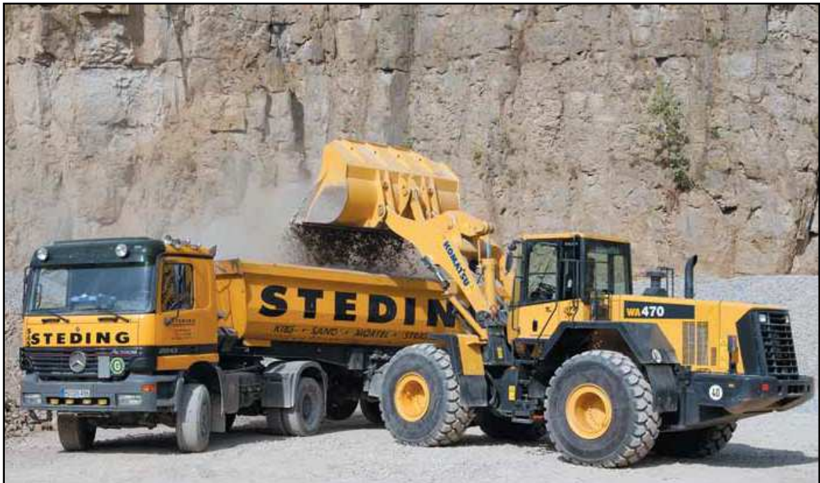
Figura nº 70 : Pala cargadora modelo WA 470 de Komatsu.
