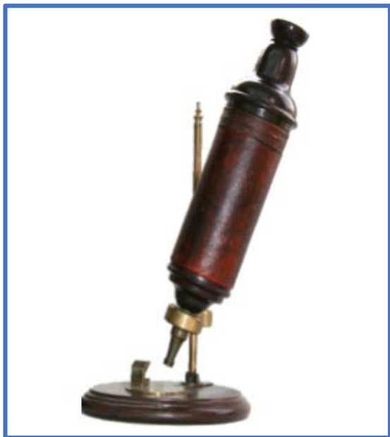
Figura 1. Microscopio compuesto utilizado por Hooke en sus investigaciones.
