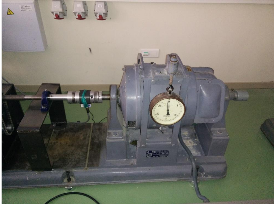
Figura nº 3.11. Dinamo-freno usada para el ensayo a plena carga
