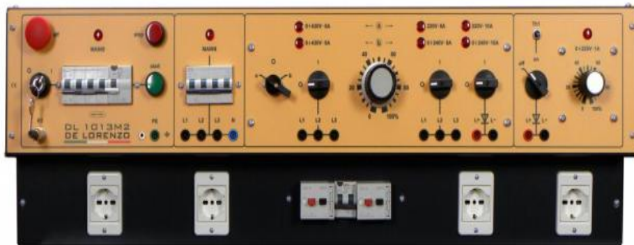
Figura nº 3.1. Fuente de tensión regulable
