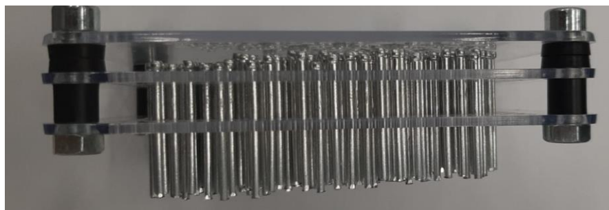
Figura 26. Alzado del útil para speckle térmico
