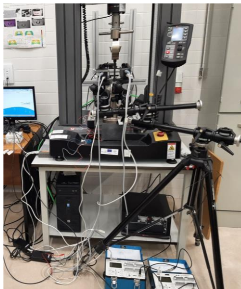
Figura 49. Esquema montaje ensayo tracción
