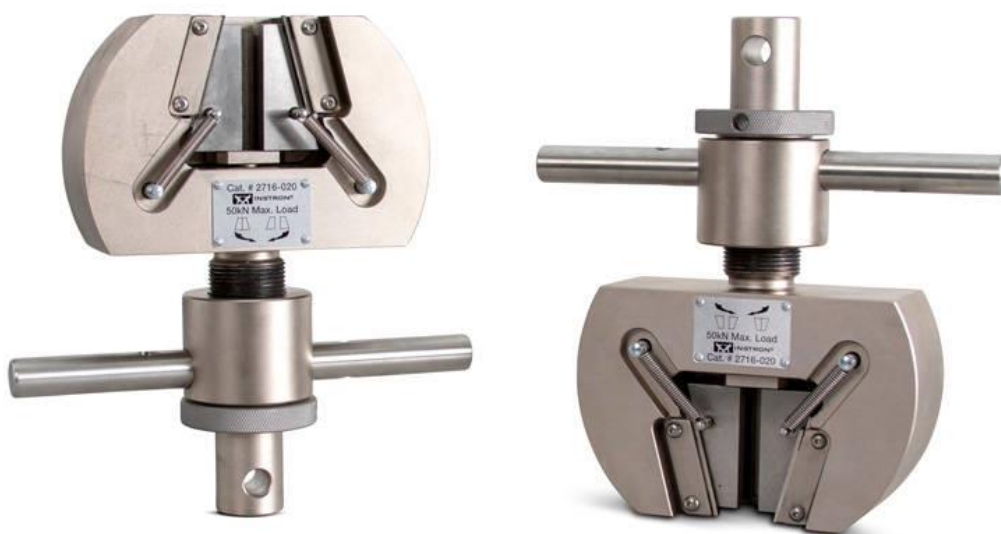
Figura 44. Mordazas para máquina de ensayo universal [32]
