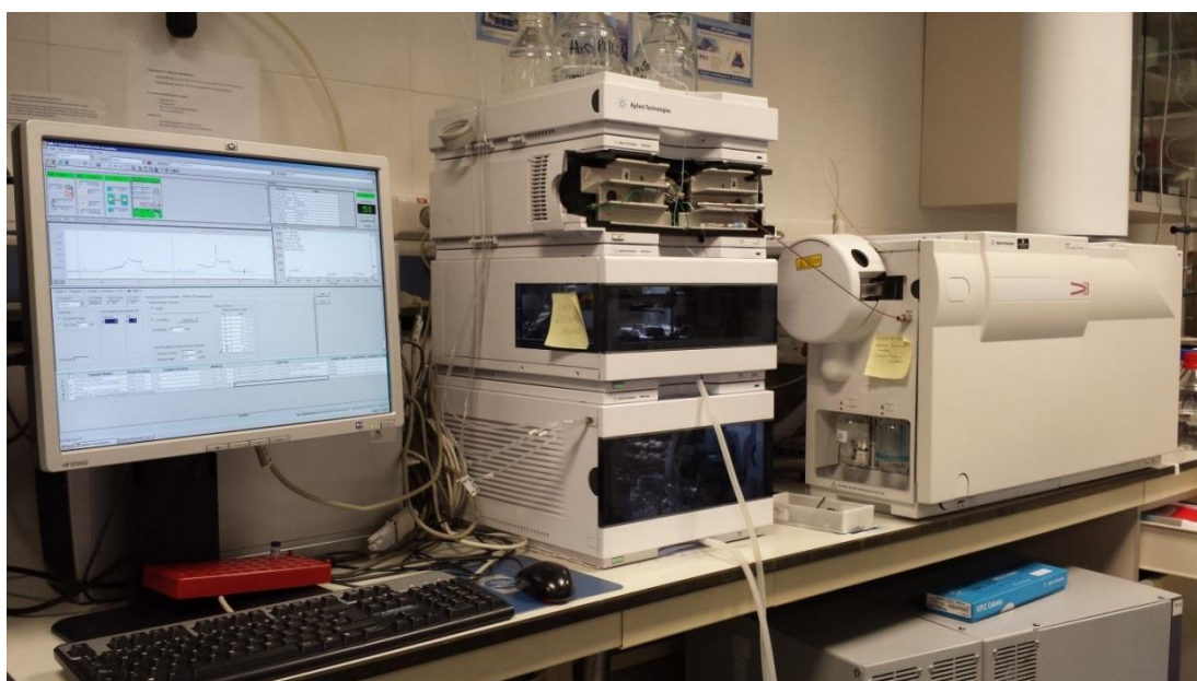
Figura 3. Equipo de cromatografía de líquidos/espectrometría de masas con analizador de tiempo de vuelo empleado en el estudio.
