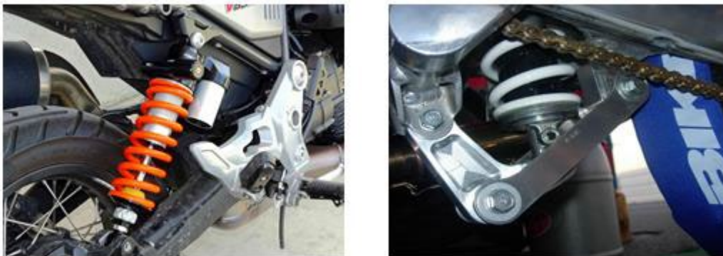
Ilustración 47. Suspensión directa (Izquierda) y de bieletas simple (Derecha)
