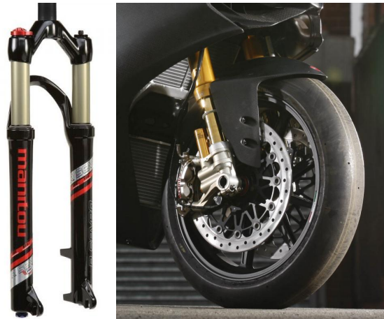
Ilustración 43. Horquilla convencional (Izquierda) y Horquilla invertida (Derecha)
