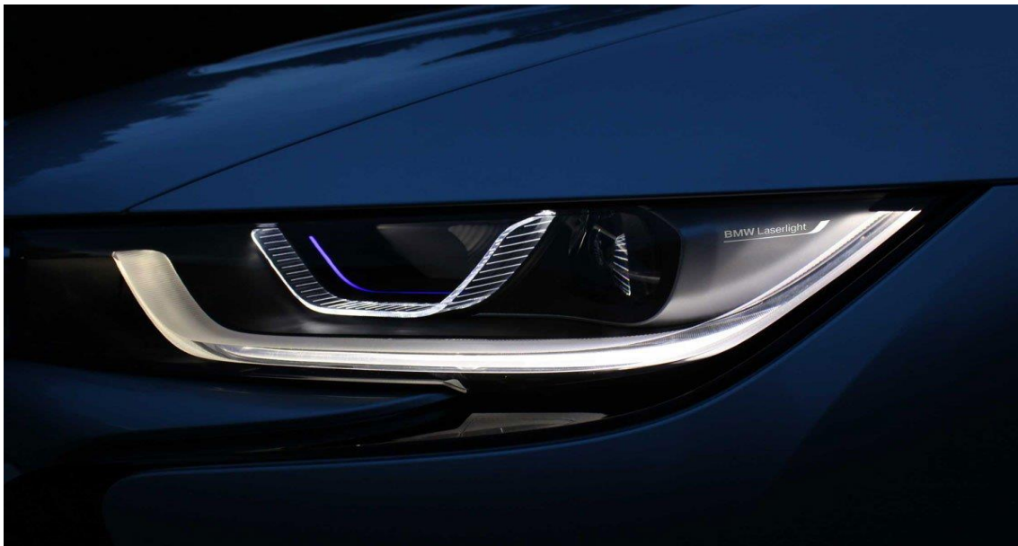
Ilustración 19: Faro de tecnología láser. [19]
