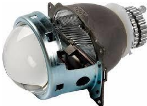
Ilustración 22: Módulo de proyección. [20]
