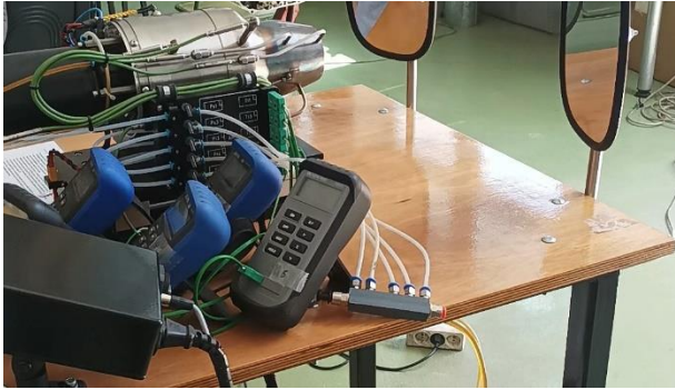
Figura 27: Turbina con la que se ha ensayado con combustible Jet A-1
