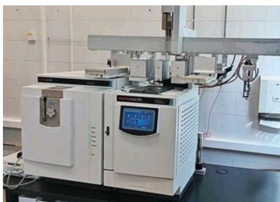
Figura 6: espectrómetro de masas Thermo Orbitrap Exploris GC 240 (izquierda) y cromatógrafo de gases Thermo Trace GC 1610 (derecha).
