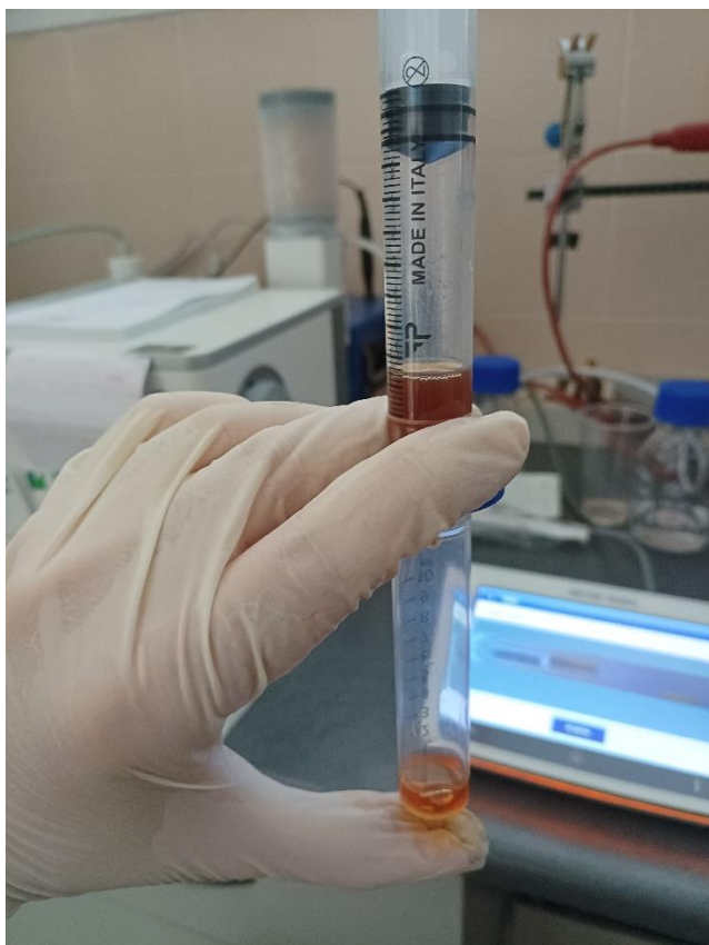
Figura 13: Proceso de filtrado directamente sobre la segunda jeringuilla
