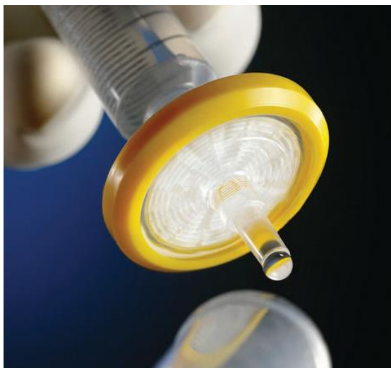
Figura 15. Filtración a través de membranas para acondicionar las muestras a HPLC.
