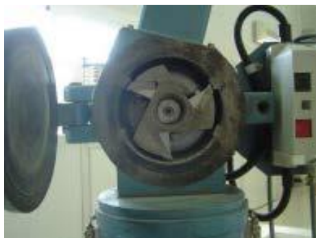
Figuras 8 y 9 Molino de cuchillas tipo Retsch (SM 100, Haan, Alemania) y Tamiz de salida de 1cm respectivamente.
