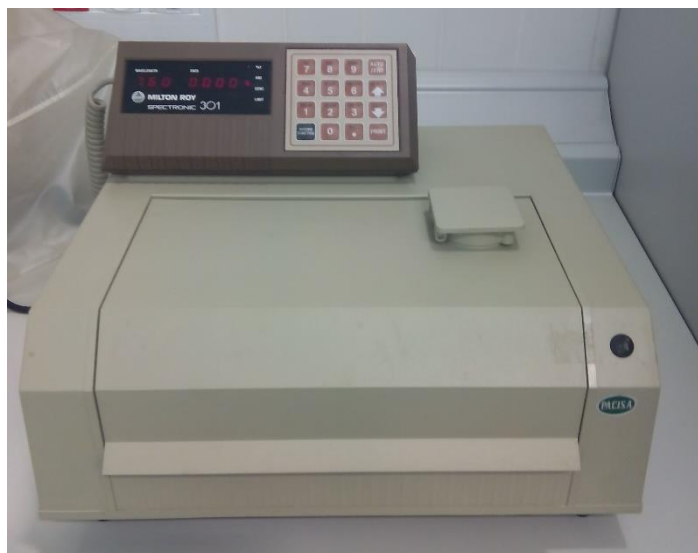
Figura 18. Espectrofotómetro Milton Roy (Spectronic 301) utilizado para medir la absorbancia a 760 nm.
