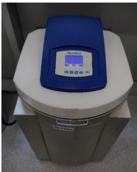
Figura 10. Autoclave utilizado para la hidrólisis.
