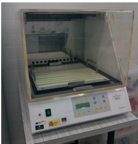
Figura 11. Orbital utilizado para la agitación y calefacción de las muestras.
