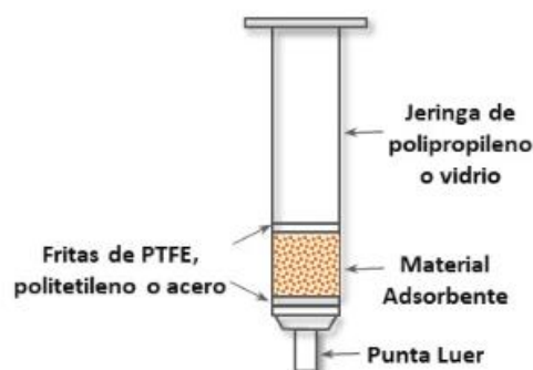
Figura 5.1. Configuración de los cartuchos empleados en la Extracción en Fase Sólida (SPE) (Fuentes Lopez et al., 2020)
