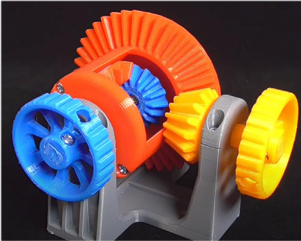
Figura 9.26: Conjunto diferencial impreso. Diseño por Thing-O-Fun, Usuario de Thingiverse. [25]
