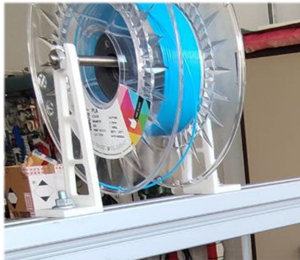
Figura 5.69: Montaje de soportes para el rollo de filamento de PLA. El taco de PVC se encuentra insertado en el rollo.
