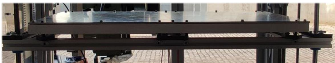
Figura 5.39: Cama de la Impresora 3D FDM CORE XY en función del diseño inicial (falta el cristal descrito, que se posiciona en cualquiera de la superficie disponible y se sujeta con
