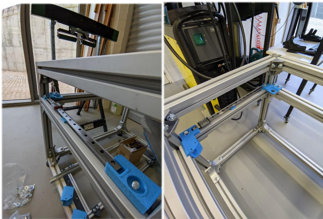
Figura 5.51: Montaje del sistema de desplazamientos izquierdo del sistema CORE XY con patín Hlwin MGN 12H y carril y piezas de PLA de sujeción y soporte. En la imagen derecha se montan piezas de PLA para soporte de motor y guía (extremo superior) y porta poleas (esquina inferior izquierda).
