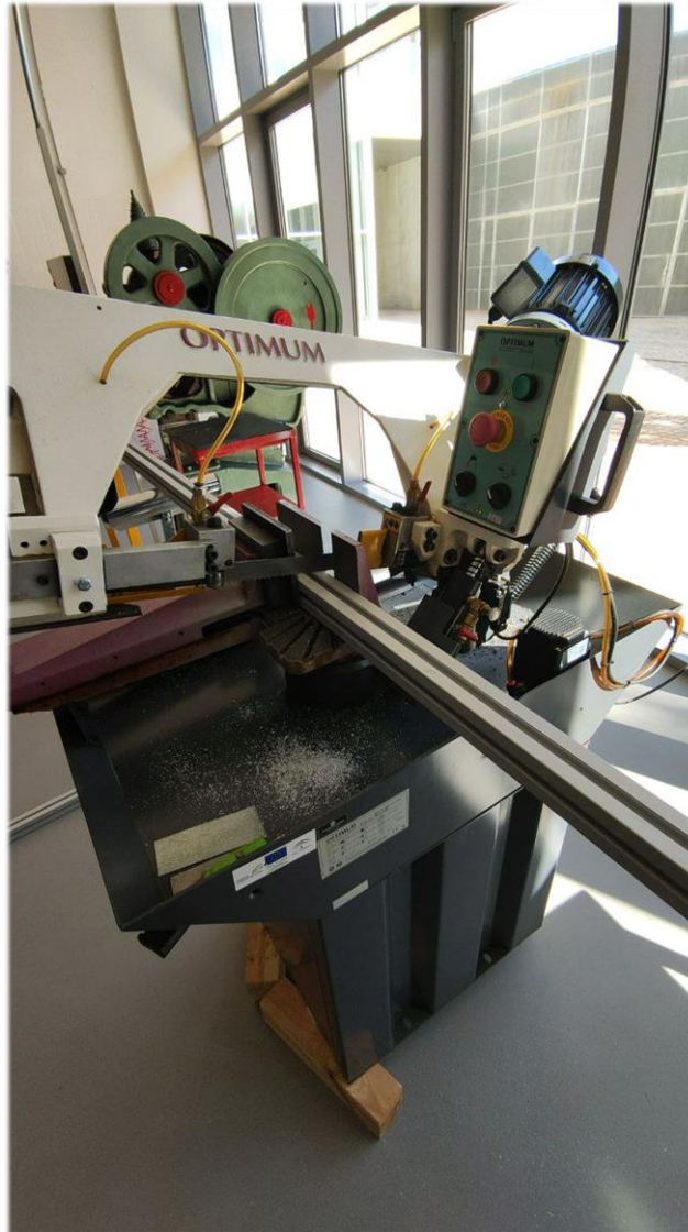
Figura 5.30: Corte de perfiles de aluminio con sierra de cinta de corte para metal OPTIMUM.
