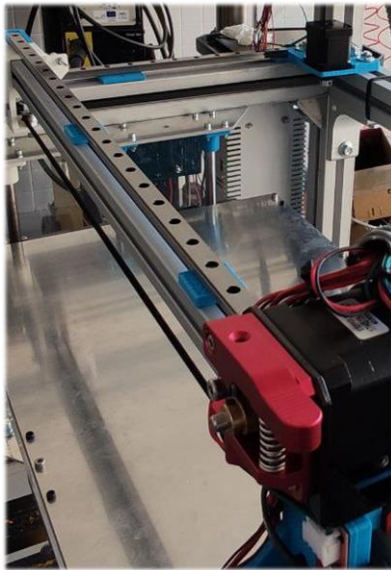
Figura 5.62: Montaje de sistema de correas del nivel inferior.
