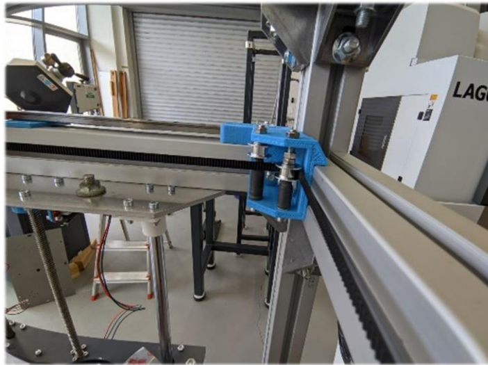
Figura 5.63: Montaje sistema de correas del nivel inferior cerrando recorrido.
