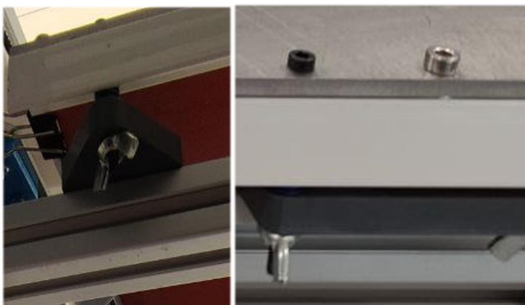
Figura 5.38: Plancha de aluminio con siliconas calefactoras y rigidizador nivelada sobre los soportes de PVC de la estructura de la cama.
