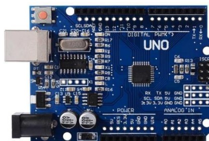
Figura 9: Arduino UNO R3
