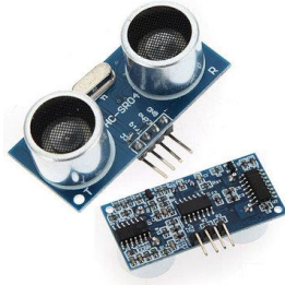
Figura 12: Sensor ultrasonidos HC-SR04
