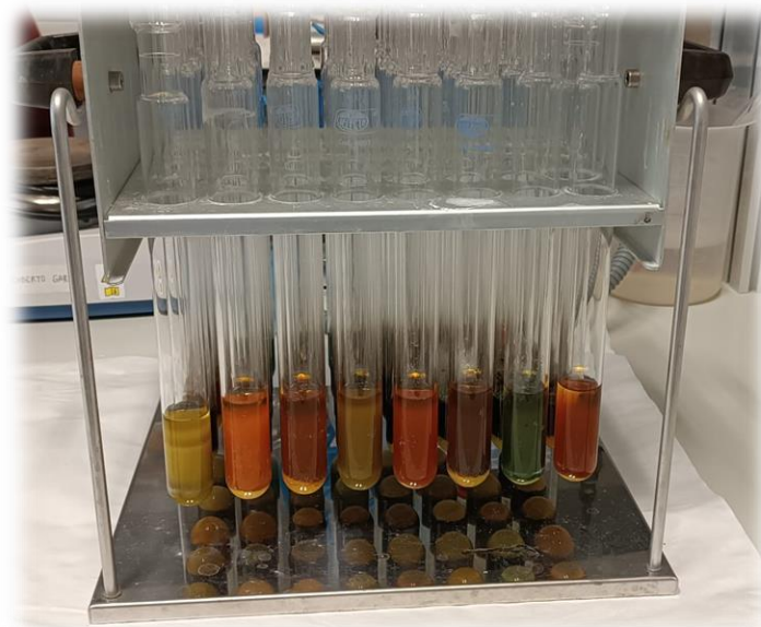
Figura 4.6. Ejemplo de color generado por distintas muestras de suelo tras la digestión con dicromato potásico y ácido sulfúrico a 150 °C durante una hora.
