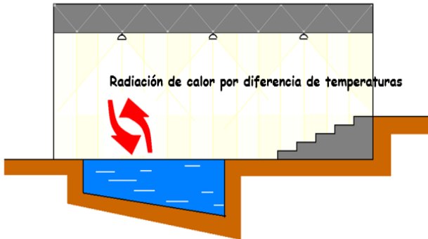
Ilustración 2. Pérdida por radiación
