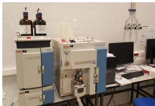
Figura 3 . Diagrama del funcionamiento del programa TSQ . Aparato localizados en el GSYA de los Servicios Técnicos de la Universidad de Jaén que nos permitió la cuantificación de hormonas vegetales mediante la técnica HPLC-espectrometría de masas de triple cuadrupolo.
