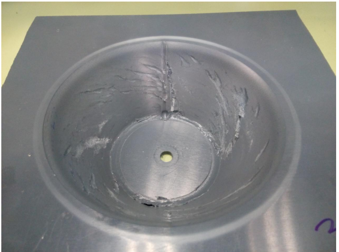
Ilustración 3.5 Fotografía del resultado del ensayo 3 a 500 rpm usando acero
