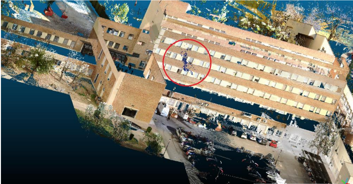
Figura 16. Nube de puntos extraña, visto desde el Sur en Cloud Compare, marcada con un círculo.
