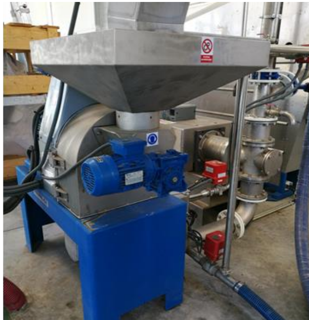
Figura 14. Molino de martillos Pieralisi de la almazara experimental del IFAPA, Centro Venta del Llano.
