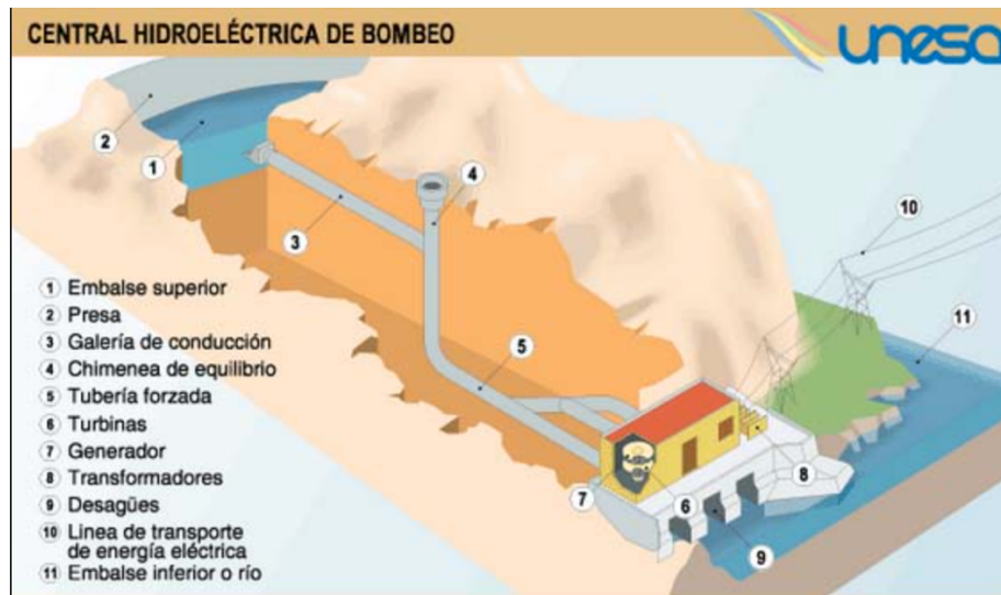
Figura 2.4 Central por bombeo
