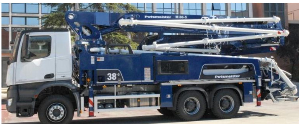
Figura 17: Camión para bombeo de hormigón.
