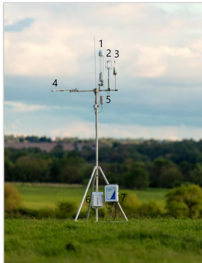
Figura 1. Ejemplo de Estación Multiparamétrica. 1-Analizador de CH 4 de Canal Abierto (Li-7700 de LI-COR); 2-Anemómetro; 3-Analizador de CO 2 /H 2 O de Canal Abierto (Li-7500DS de LI-COR); 4-Radiómetro; 5-Sensor de temperatura y humedad del aire; 6-Unidad de lavado para los diferentes sensores; 7-Unidad de Interfaz del Analizador (Li-7550). Imagen propiedad de LI-COR (LI-COR Biosciences, 2023).
