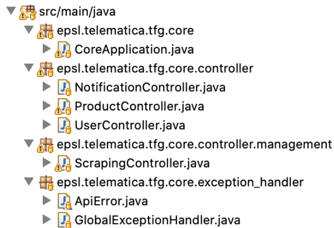
Figura 3. Estructura de paquetes del módulo core
