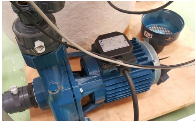
Imagen 24: Bomba centrífuga del puesto
