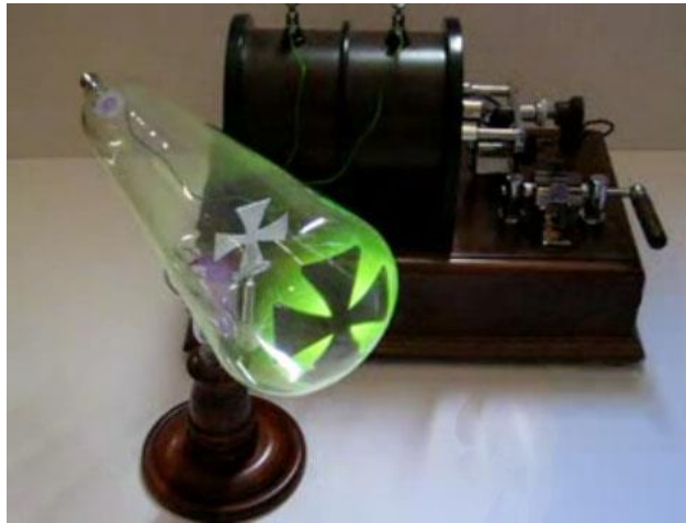
Figura 1.1. Tubo de descarga de Crookes con cruz de malta. [Figueroa-fagadini, 2017].
