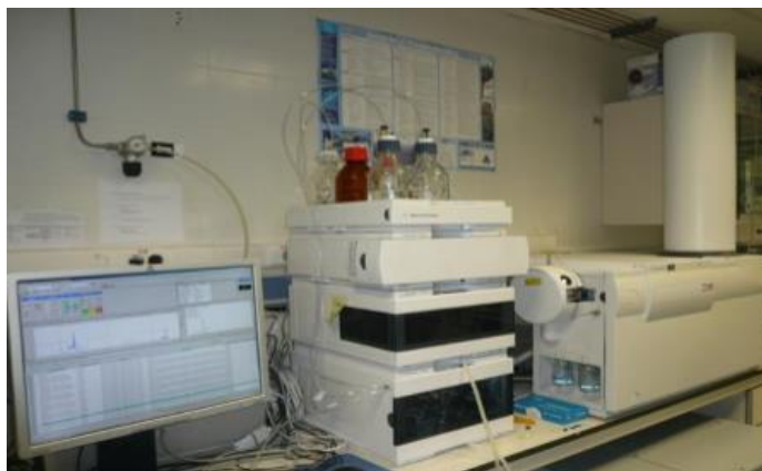
Figura 3.1: Equipo cromatográfico con espectrómetro de masas con analizador TOF acoplado.
