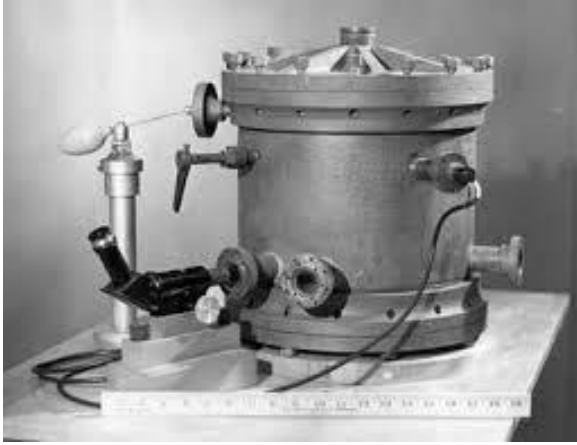
Figura 1.6. Cámara de niebla empleada por R. Millikan [Wales, Sanger, 2018].
