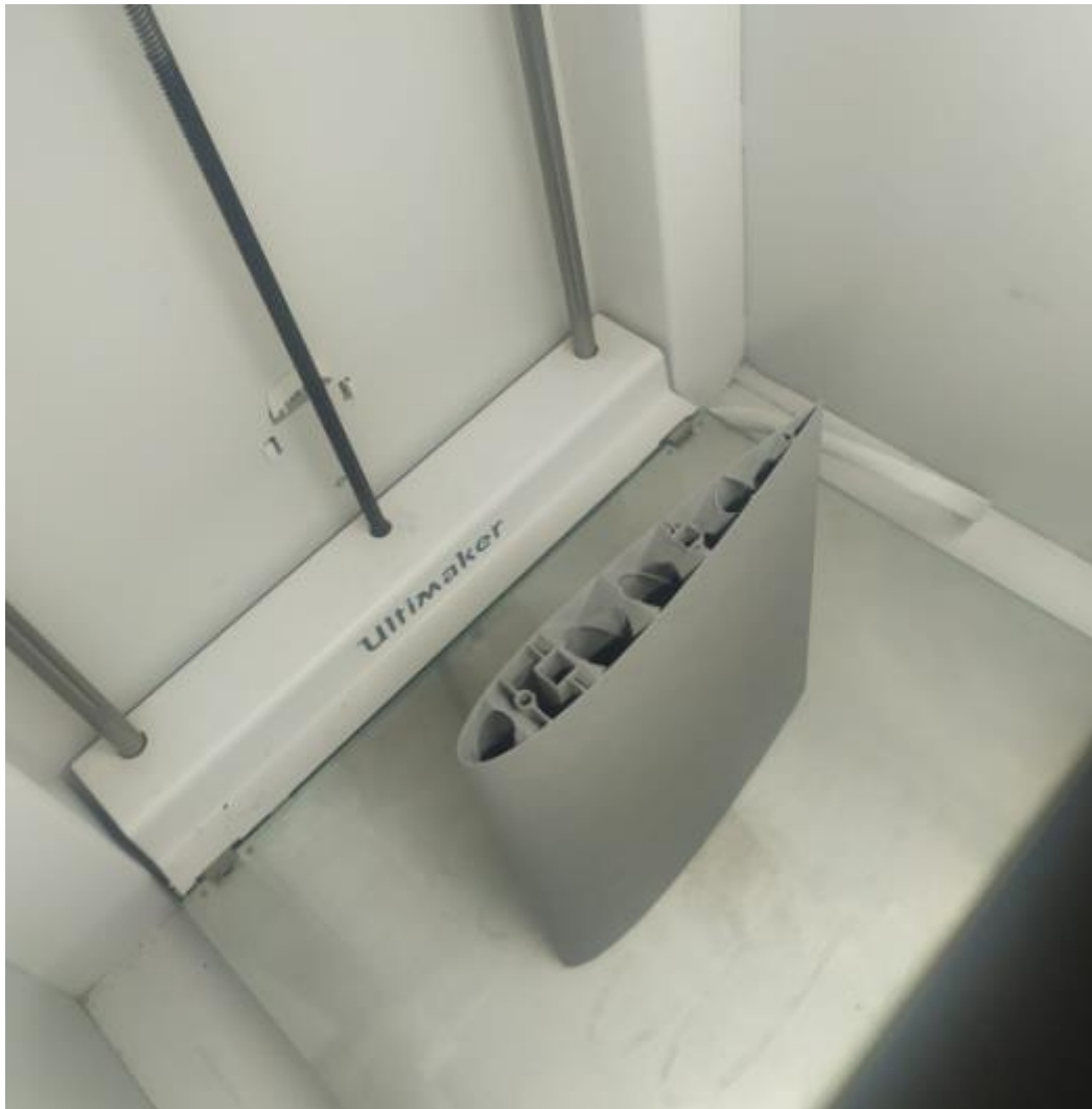
Ilustración 81-Segmento de 20 cm impreso en LW-Pla en la Ultimaker S5
