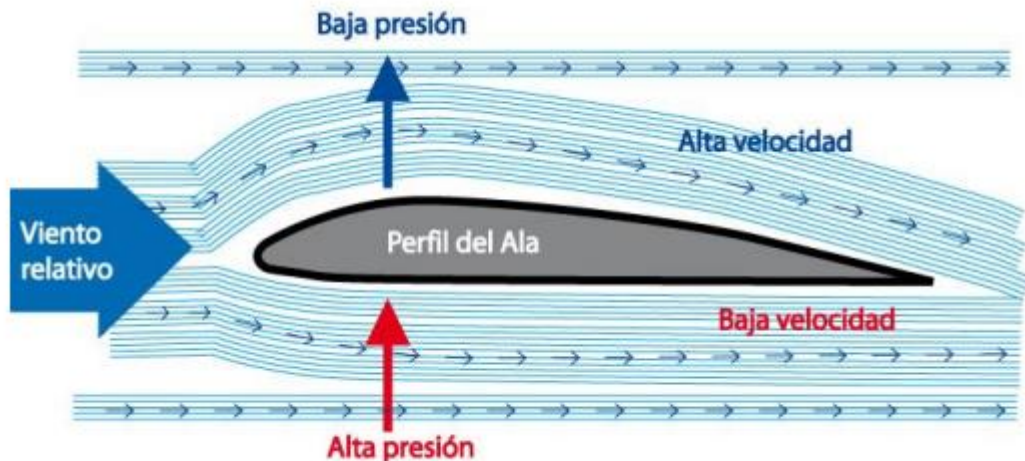
Figura 3.11: Principio de Bernoulli aplicado al perfil alar (Fuente: Alas)
