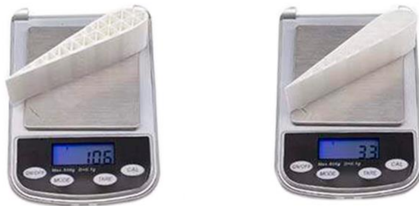
Ilustración 60-Diferencia de peso entre un segmento de álabes impreso con PLA y LW-PLA
