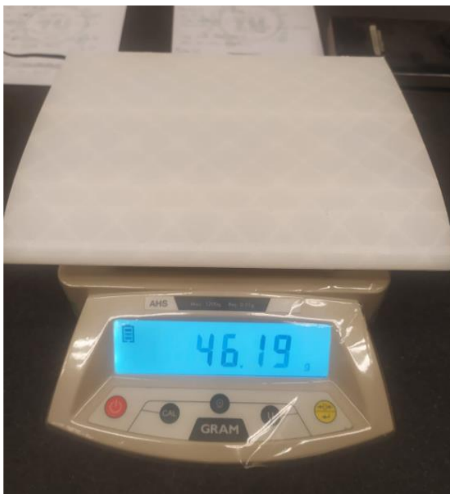
Ilustración 73-Peso de un segmento de 20 cm del diseño en PLA
