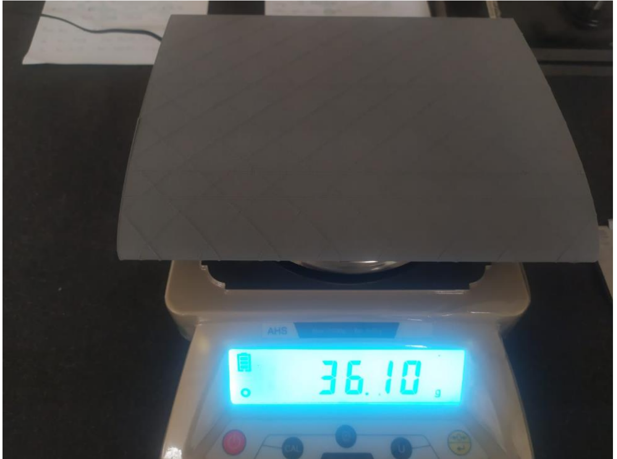
Ilustración 82-Peso de un segmento de 20 cm en LW-PLA
