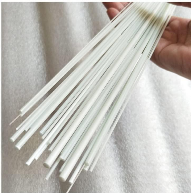
Ilustración 30-Varillas de fibra de vidrio
