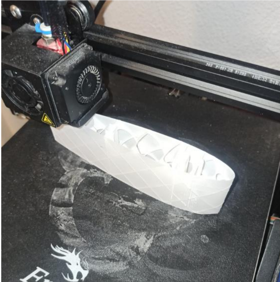
Ilustración 78-Impresora Ender 3 imprimiendo el prototipo final del álabes en PLA
