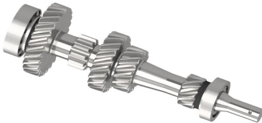
Figura 4.44. Modelo eje primario con piñones, rodamientos y retenes.
