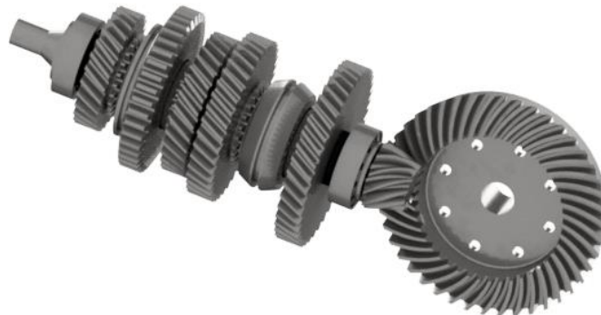
Figura 4.89. Conjunto de eje secundario y elementos con el grupo cónico.
