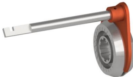
Figura 4.112. Conjunto del sincronizador, horquilla y eje de mando de 1ª y 2ª.
