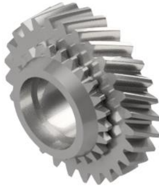
Figura 4.35. Modelo engrane cuarta velocidad.
