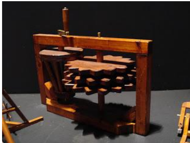
Ilustración 1.1. Modelo caja de cambios de Leonardo da Vinci
