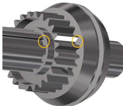
Figura 5.3. Zonas de contacto entre dentados.
