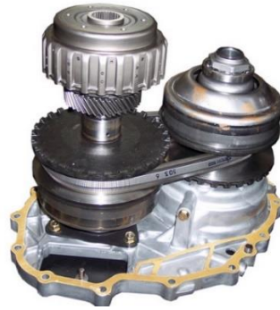
Ilustración 1.8. Sistema de transmisión variable continua
