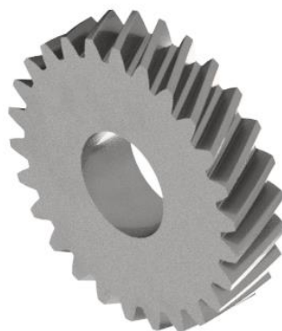
Figura 4.23. Modelo piñón cuarta velocidad.
