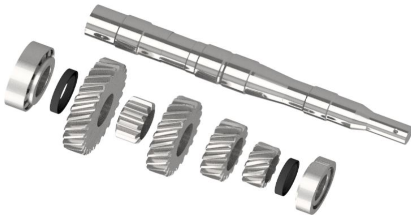
Figura 4.45. Modelo explosionado eje primario con otros elementos.
