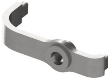
Figura 4.120. Modelo de la horquilla de marcha atrás.
