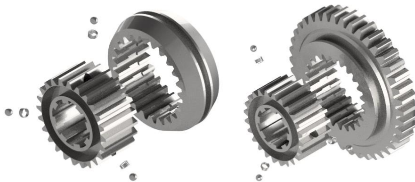
Figura 4.79. Explosión del modelo sincronizador de 1ª y 2ª.
