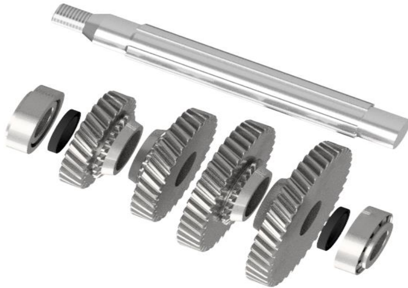
Figura 4.53. Modelo explosionado eje secundario y otros elementos
