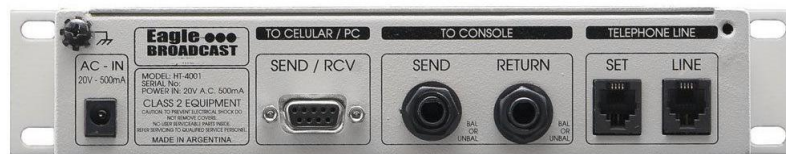
Figura 3.6. Eagle HT4001, ejemplo de híbrido telefónico.
