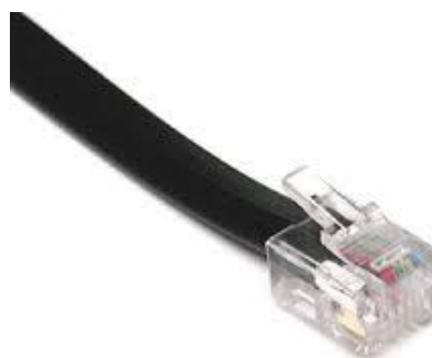
Figura 3.21. Cable telefónico y conector RJ-11.
