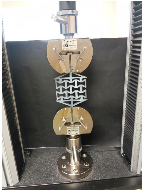
Ilustración 66: Colocación de la estructura en la máquina de ensayos.
