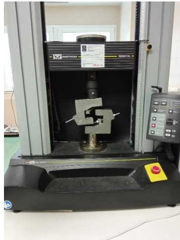
Ilustración 39: Máquina universal de ensayos 'Instron'.
