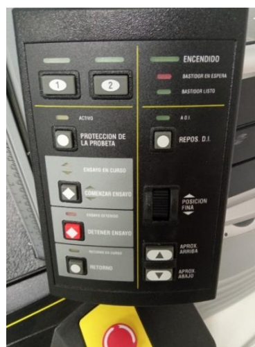
Ilustración 40: Controles para desplazamiento de las mordazas.
