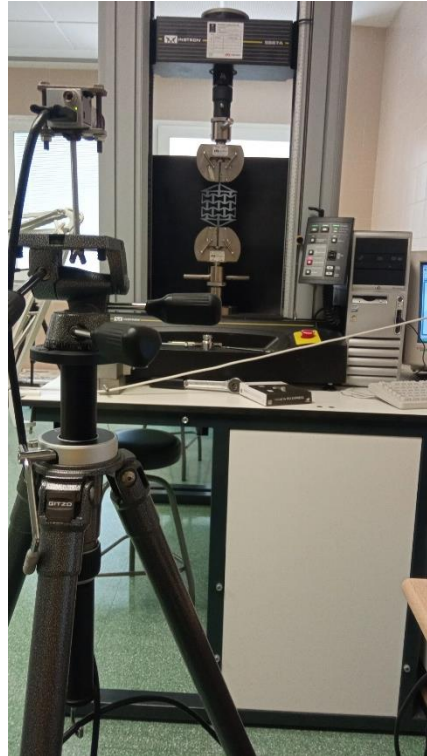
Ilustración 77: Montaje para la obtención de imágenes.
