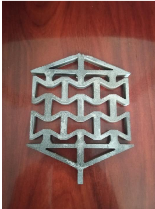
Ilustración 76: Estructura honeycomb tras aplicar la carga de rotura.
