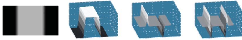
Ilustración 26. Una imagen simple en escala de grises (izquierda), junto con la magnitud de intensidad (centro izquierda), la función de primera derivada (centro derecha) y la función de segunda derivada (derecha) [47].
