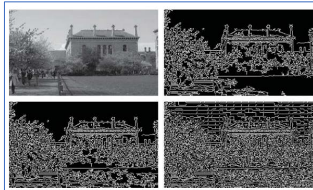
Ilustración 29. Detección de bordes de Canny. Las tres imágenes de Canny utilizan el mismo filtro de suavizado, pero diferentes umbrales de gradiente bajo y alto (7 y 236 – superior derecho, 7 y 100 – inferior izquierdo, 1 y 1 – inferior derecho). La imagen inferior derecha muestra todos los bordes posibles y las otras dos muestran algunos de los efectos de los umbrales [42].
