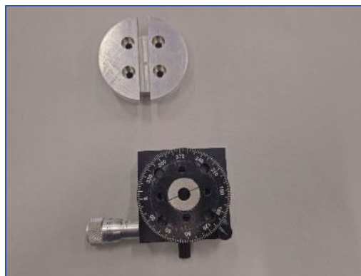
Ilustración 38. Imagen que muestra tanto la base de la placa como el goniómetro [Elaboración propia].
