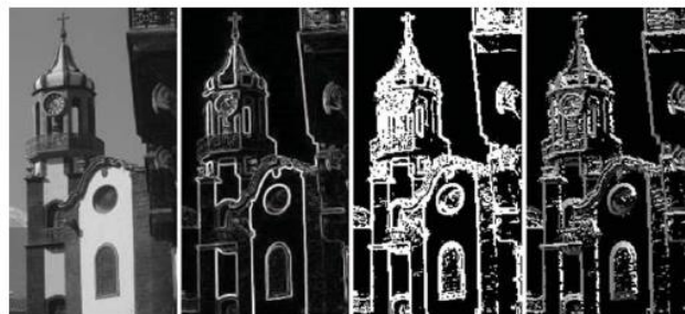
Ilustración 24. Una imagen en escala de grises de una iglesia (izquierda), la magnitud del gradiente de borde de Sobel (centro izquierda), una versión umbralizada de la magnitud del gradiente (centro derecha) y las orientaciones de Sobel correspondientes (derecha) [47]
