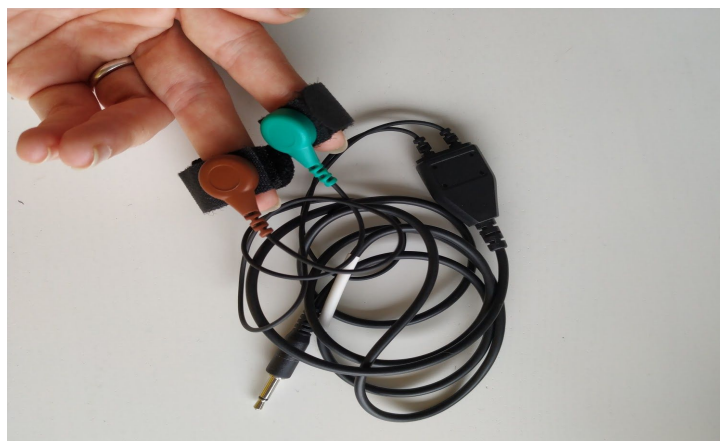
Ilustración 4.3. Sensor de conductividad de la piel
