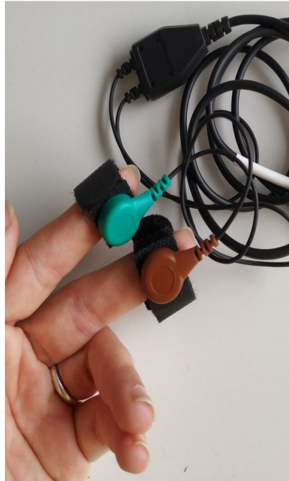
Ilustración 9. Colocación sensor de conductividad
