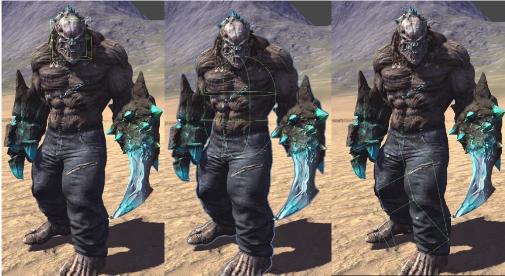
Ilustración 20. Colisionadores de las distintas partes del modelo de Mutante
