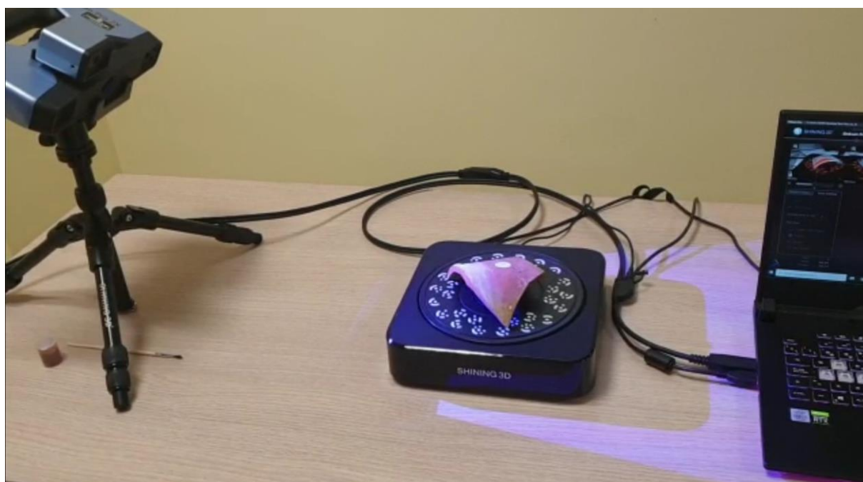
Ilustración 108: Escaneado con el escáner EinScan Pro 2X
