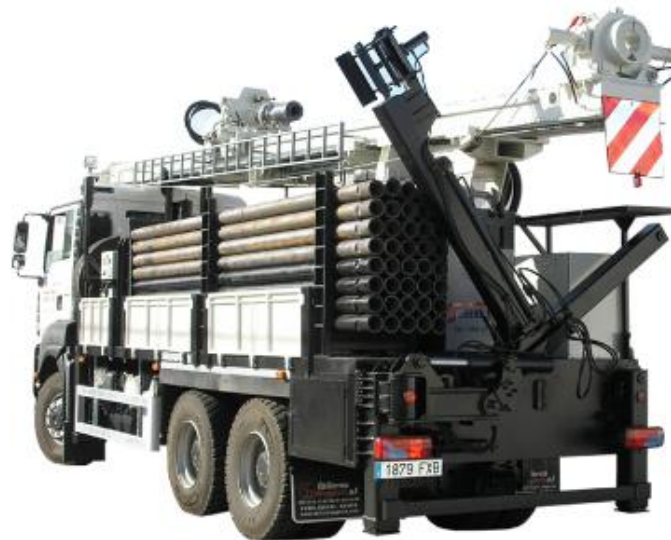
Fig. 67 Lateral camión SEGOQUI - 21 con perforadora.
