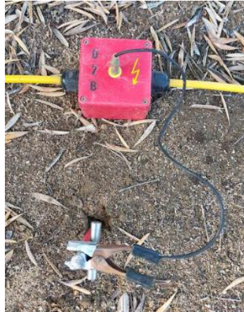
Fig. 38 Conexión conector y electrodo mediante pinza de cobre.
