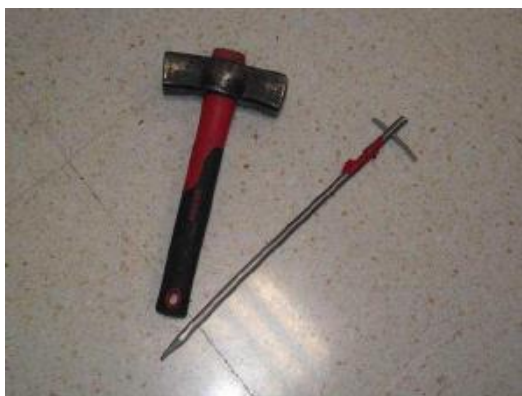
Fig. 24 Electrodo y maceta para su hincado en el terreno.
