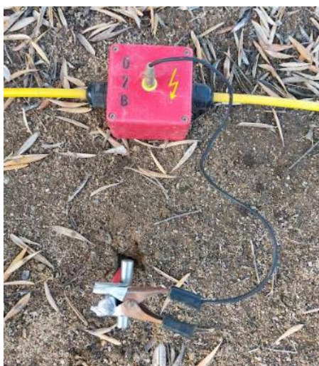
Fig. 25 Conexión entre conector y electrodo.
