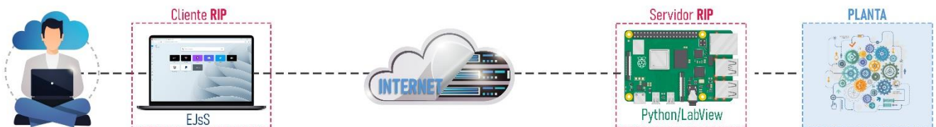
Figura 3-15.- Esquema general comunicaciones
