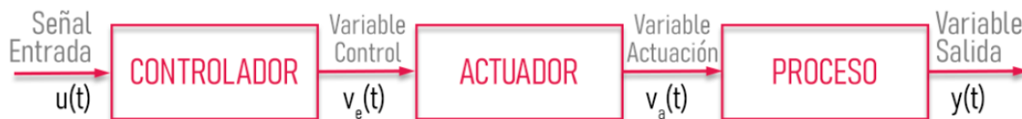
Figura 4-18.- Sistema de Control en bucle abierto
