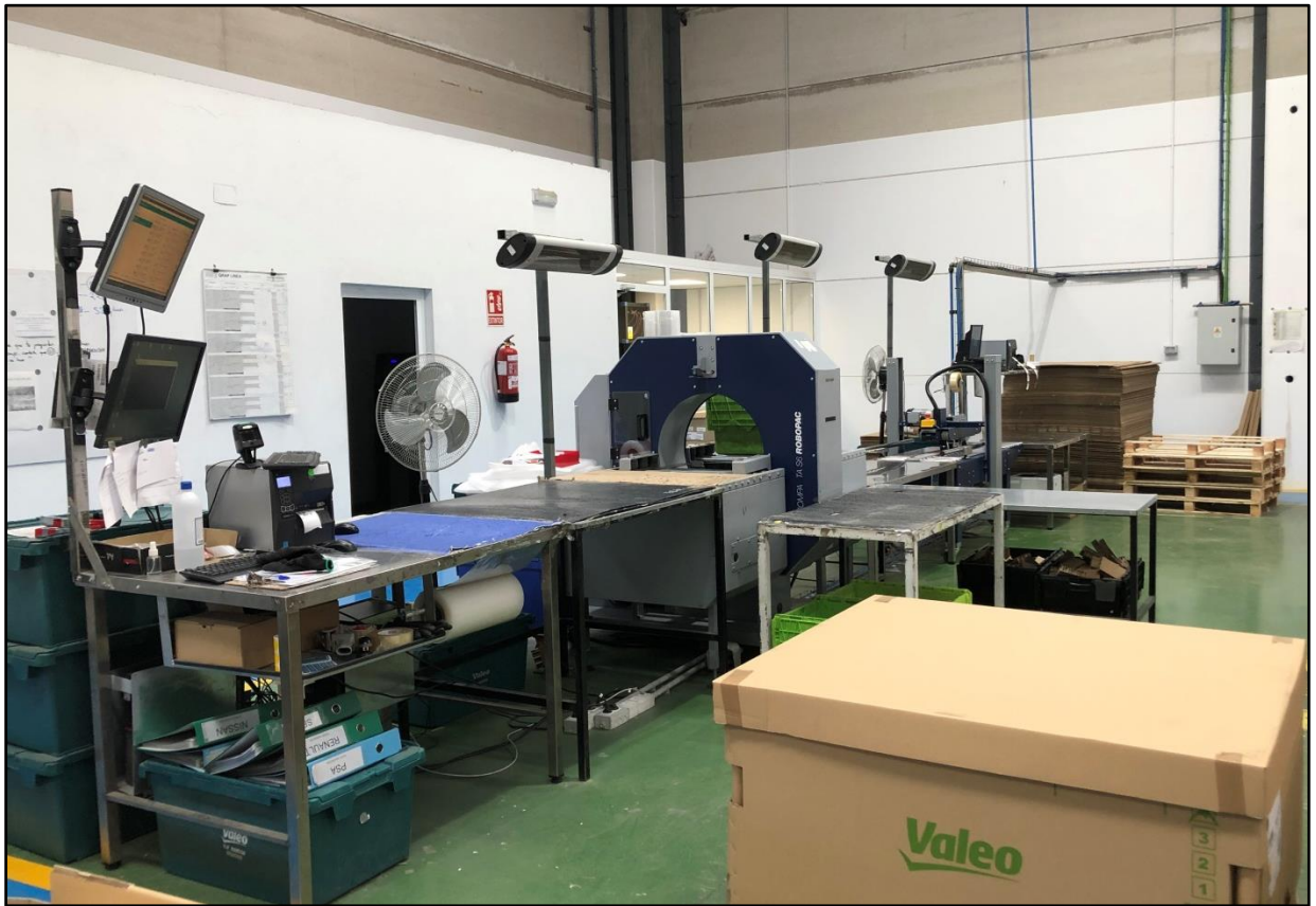
Figura 4.8. Línea de embalaje (Fotografía del autor)
