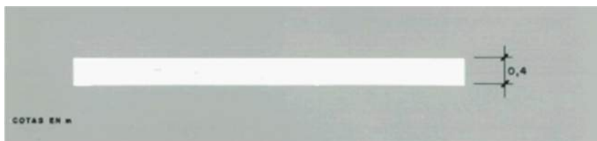
Figura 1.5 – Composición de línea de STOP 4-4.1
