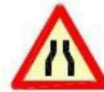
TP-17 ESTRECHAMIENTO DE CALZADA
