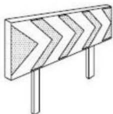
PANELES DIRECCIONALES PARA CURVAS
