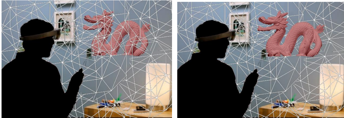
Ilustración 5.11 - Comparativa de mala (izq.) y buena (der.) ubicación de modelos
