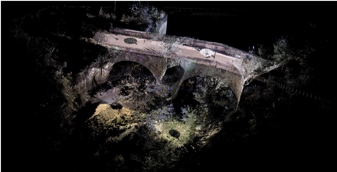
Ilustración 5.18 - Ejemplo de nube de puntos en PLY binario
