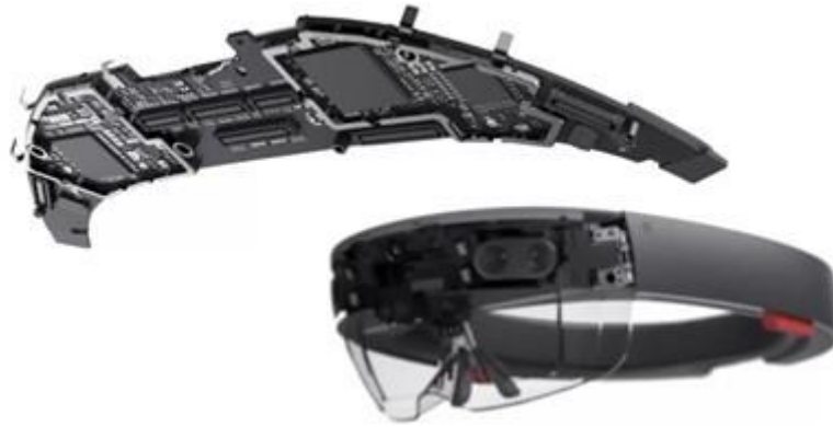
Ilustración 3.2 - Placa base de Hololens
