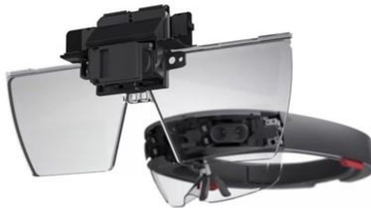
Ilustración 3.3 - Parte óptica de Hololens
