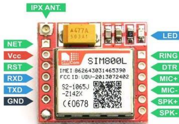
Figura 11 Esquema pinout del SIM800L
