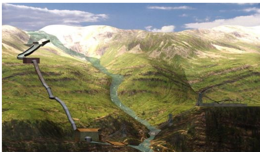
Figura 24. Esquema central de agua fluyente (Fuente: (Ogayar, 2012))
