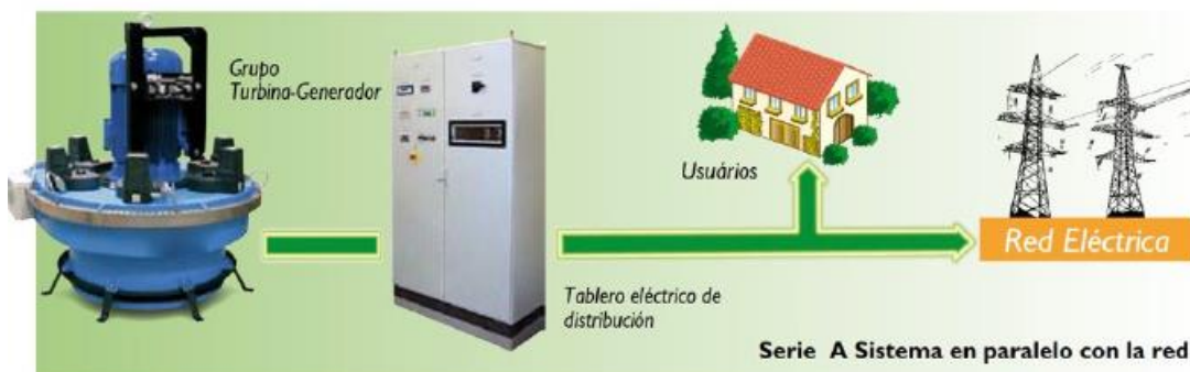
Figura 20. Esquema del funcionamiento del grupo turbina-generator dentro del sistema eléctrico (Fuente: Elaboración Propia)
