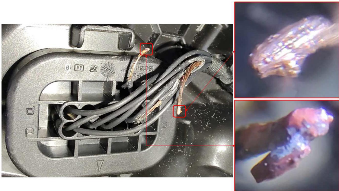
Figura 38.- Cable del conector principal seccionado.
