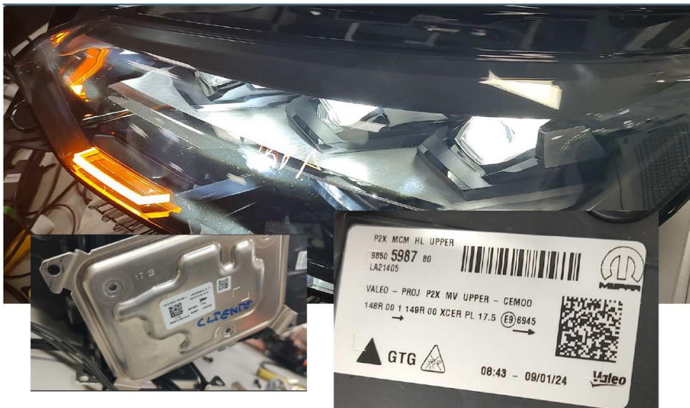
Figura 36.- Proyector OK con driver del proyector KO.
