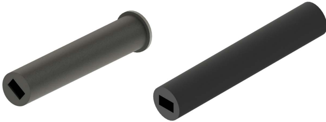
Figura 56: Rodillo motriz (izq.) y rodillo auxiliar (der.).
