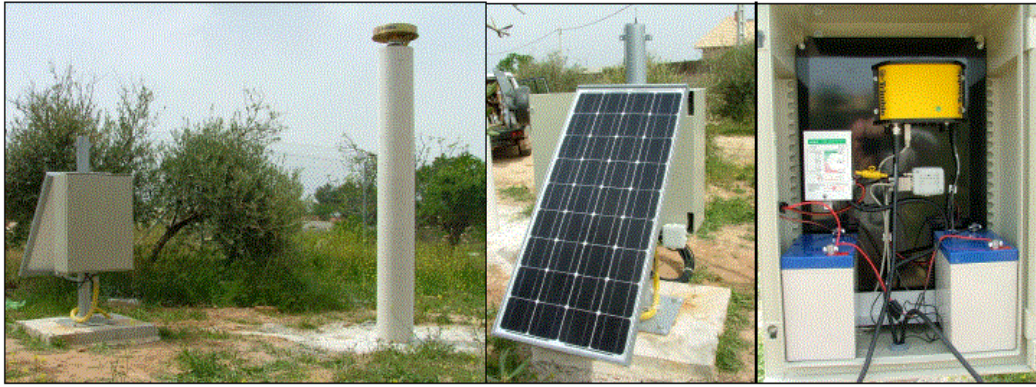
Figura 10.- Estación TGIL de la red Topo-Iberia (DE LACY, y otros, 2014)
