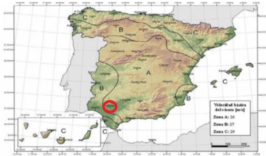
Figura 4.2-a Mapa de isotacas para la obtención de la velocidad básica fundamental del viento v_{b,0} (Coincide con el mapa correspondiente del Código Técnico de la Edificación)
