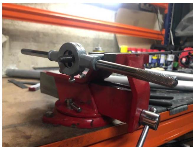
Ilustración 100: Forjado de rosca con terraja
