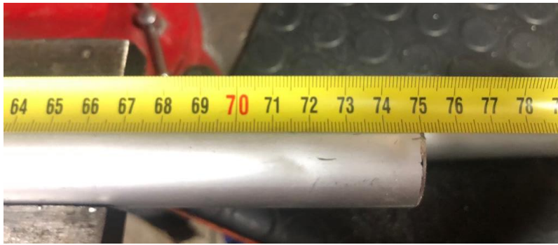
Ilustración 107: Comprobación longitud de pieza
