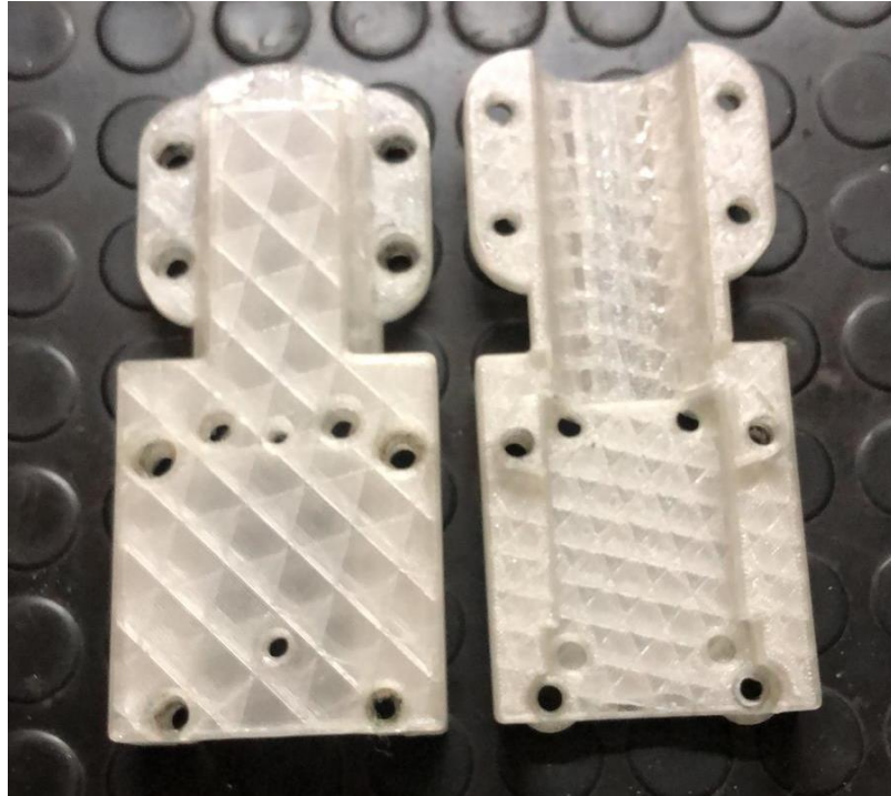
Ilustración 86: Conexión Bancada-Pértiga realizada por fabricación aditiva
