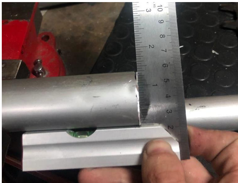
Ilustración 108: Comprobación ángulo de corte a 90º
