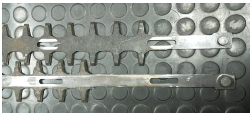
Ilustración 103: Comparación de una cuchilla cortada con otra sin cortar
