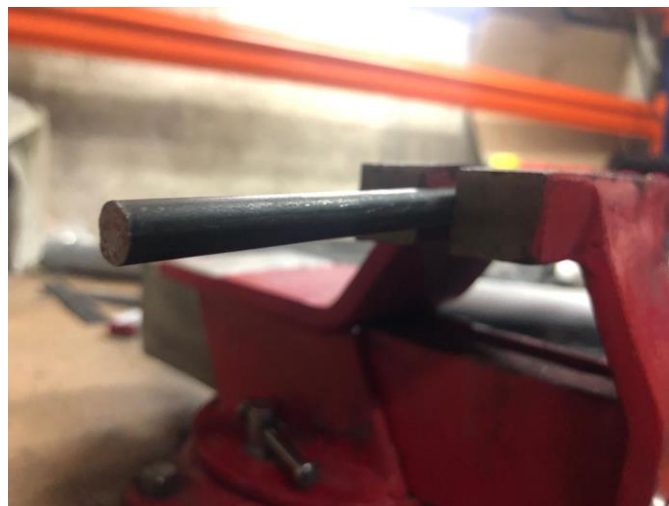
Ilustración 99: Varilla m8 cortada a 90°
