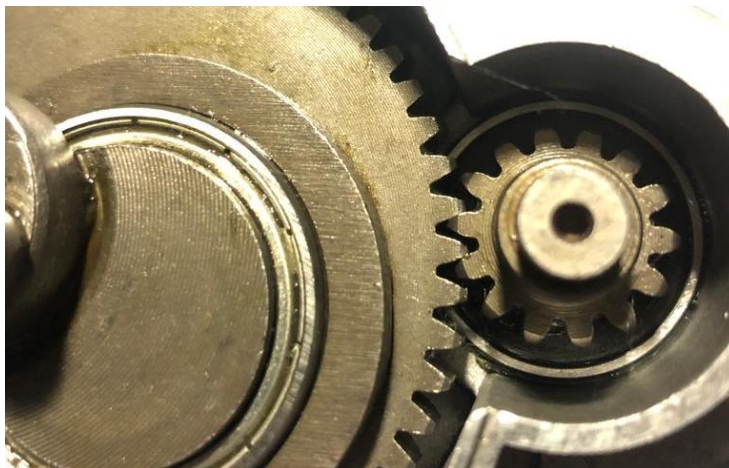
Ilustración 135: Engranajes reductores de velocidad
