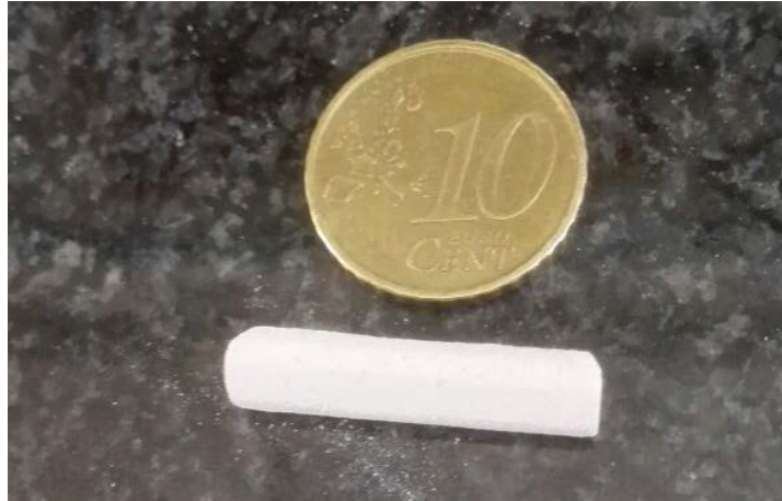
Figura 26: Probeta de sepiolita utilizada en el dilatómetro.
