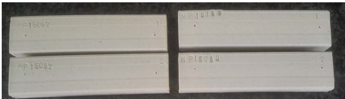
Figura 27: Probetas de las dos tipos de mezclas obtenidas por extrusión.
