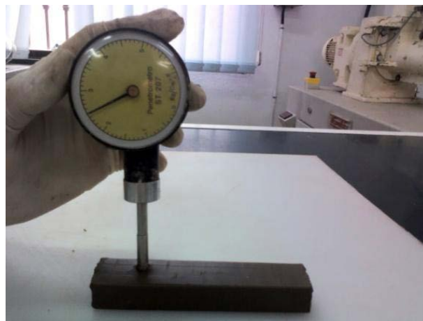
Figura 14: Control de la consistencia con el penetrómetro de bolsillo.
