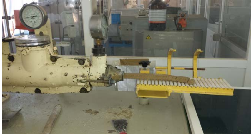
Figura 13: Salida del material de la extrusora.
