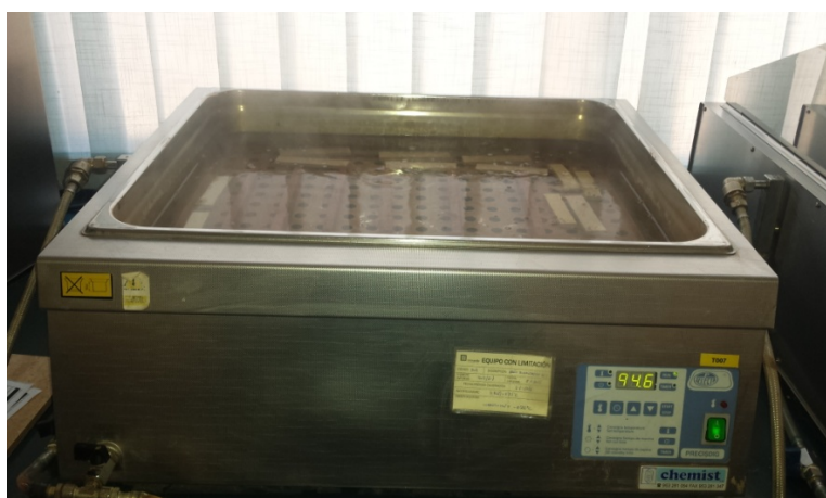
Figura 20: Inmersión de probetas para la determinación de absorción de agua.
