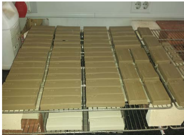
Figura 15: Probetas de la mezcla 1 secas (de color más claro) y probetas de la mezcla 2 húmedas (más oscuras).
