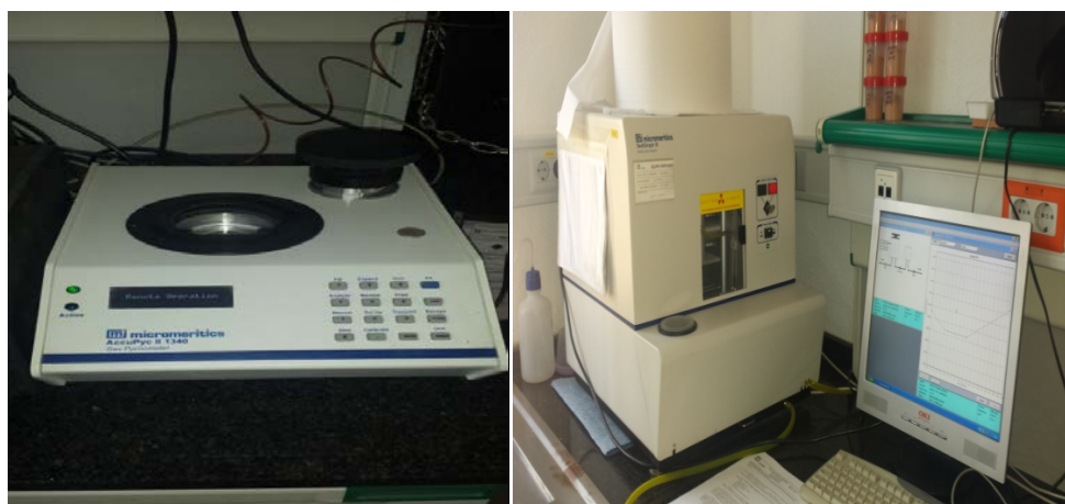
Figura 5: Picnómetro de Helio (izquierda) y equipo Sedigraph (derecha).
