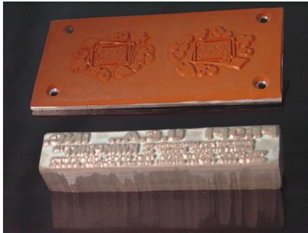
Figura 20: Cliché de acero para estampación. Fuente: Propi USA.
