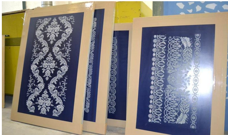
Figura 27: Pantalla serigráfica. Fuente: Newgraphf.
